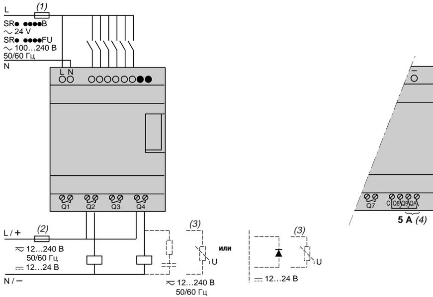
(1) Быстродействующий предохранитель 1А или автоматический выключатель.
