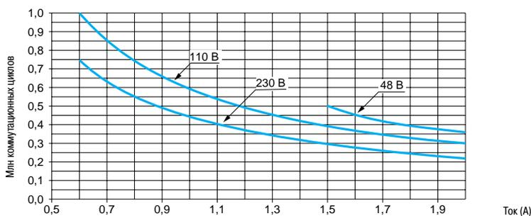
(1) АС-12: управление омическими и статическими нагрузками, развязанными посредством оптрона,  $\cos \geq 0,9$ .
